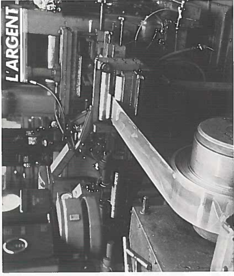
Plusieurs passages dans le laminoir seront nécessaires pour que la barre d'argent devienne une plaque.
